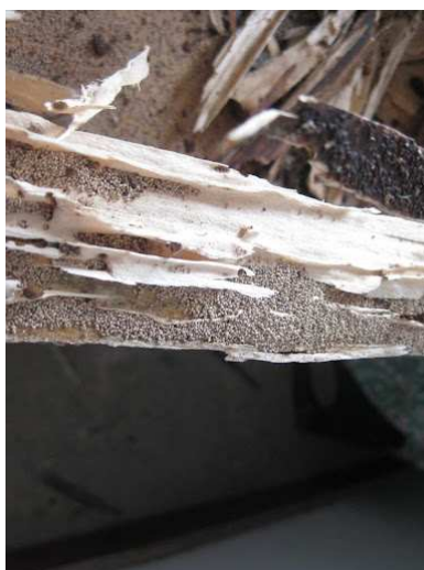
Figura 3: Destruição de mobiliário por colónia de C. brevis (Fonte: Equipa de Monitorização e Controlo das Térmitas dos Açores – Grupo da Biodiversidade dos Açores)
